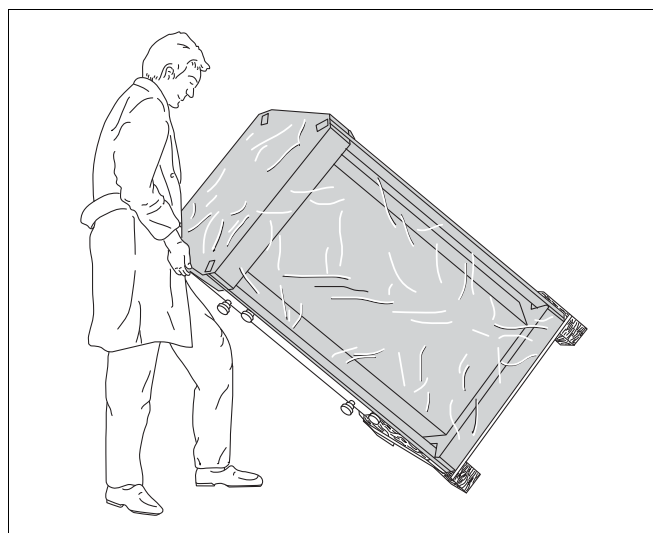
Sl. 4 Postavljanje boilerja na tla
